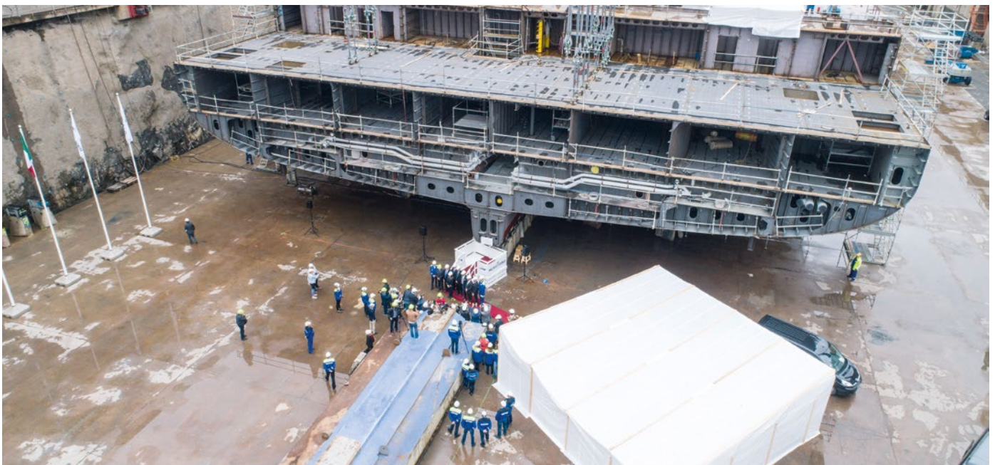
Im Unterschied zu dem überdachten Dock in Papenburg werden die Kreuzfahrtschiffe in den offenen Docks in Turku in voller Länge vom Tank- bis zum Aussichtsdeck aufgebaut
